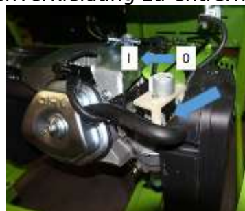
Drosselklappe Pos. 0 für Startvorgang. Pos. I im Betrieb.
